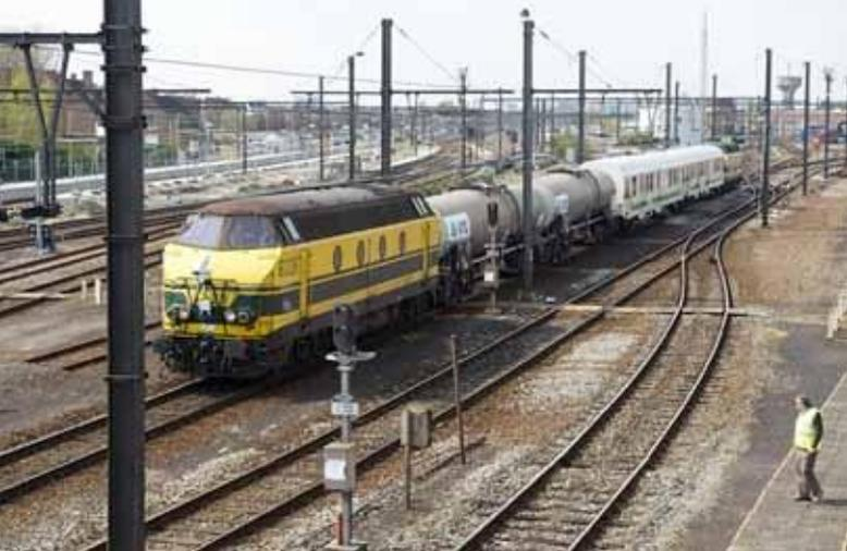
Prenez une voiture d'épandage composée d'une salle de commande, une salle des pompes et dotée d'un groupe électrogène, une voiture comprenant des facilités pour le personnel, 2 wagons citernes pleins d'eau, et 2 locomotives Infrabel, et vous obtiendrez un train de dés-herbage prêt à travailler à 60 km/h avec une autonomie de 3 à 4 jours !
