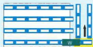
Un transbordeur est une plateforme mobile qui se déplace transversalement au-dessus des voies de travail de l'atelier pour transférer rapidement du matériel d'une voie à l'autre.
