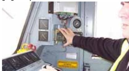
Alle seinen in hoofdspoor op het Belgische netwerk zijn met de krokodil uitgerust. Het is een eenvoudig en robuust systeem dat relatief gemakkelijk te installeren is en ook compatibel is met al het rollend materieel van NMBS.
