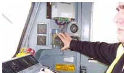
systèmes d'aide à la conduite (gong-sifflet, Mémor, TBL1, TBL1+) rappellent la signalisation lumineuse dans le poste de conduite et aident le conducteur à rester vigilant.
