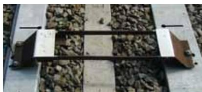
Le conducteur doit toujours confirmer manuellement qu'il a bien reçu l'avertissement de franchissement d'un signal double jaune. S'il ne le fait pas, le train s'immobilisera automatiquement. Mais, cette fois, si le conducteur dépasse quand même le signal rouge malgré sa confirmation au signal double jaune précédent, le train sera stoppé automatiquement par un freinage d'urgence suite au message reçu de la balise TBL1 placée au pied du signal.
