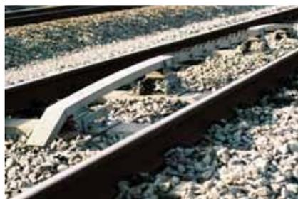
Le système **gong-sifflet** répète à bord les indications restrictives de la signalisation et contrôle la vigilance du conducteur.
