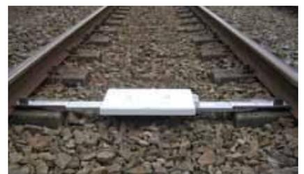
Comme dans le cas de la TBL1, si le train vient quand même à dépasser le feu rouge, le point d'information au pied du signal entraînera le freinage d'urgence pour stopper le train automatiquement.
