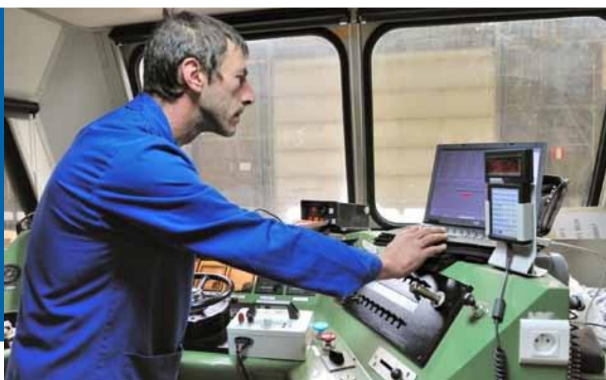
Hugues Ducarme teste les équipements TBL1+ installés à bord de la voiture pilote.
