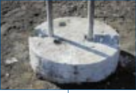
TÊTE DE PIEU MUNIE DES TUBES EXTENSOMÉTRIQUES.
