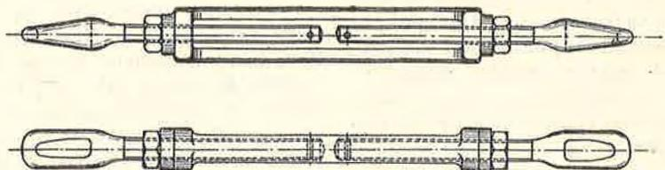
Fig. 40. — Tendeur de réglage pour transmissions funiculaires.
