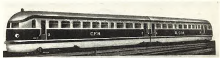
Afb. 5. Diesel-electrische automotrice (410 pk) der Belgische Spoorwegen.
