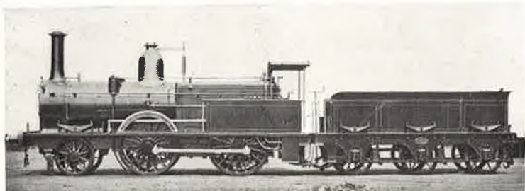
Afb. 4. 1-B locomotief van „Mechelen—Terneuzen”, gebouwd in 1871—72 bij Beyer Peacock te Manchester.
