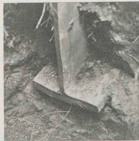
Fig. 16. Breuk in onderrand in moedermateriaal; let op structuur breukvlak.
