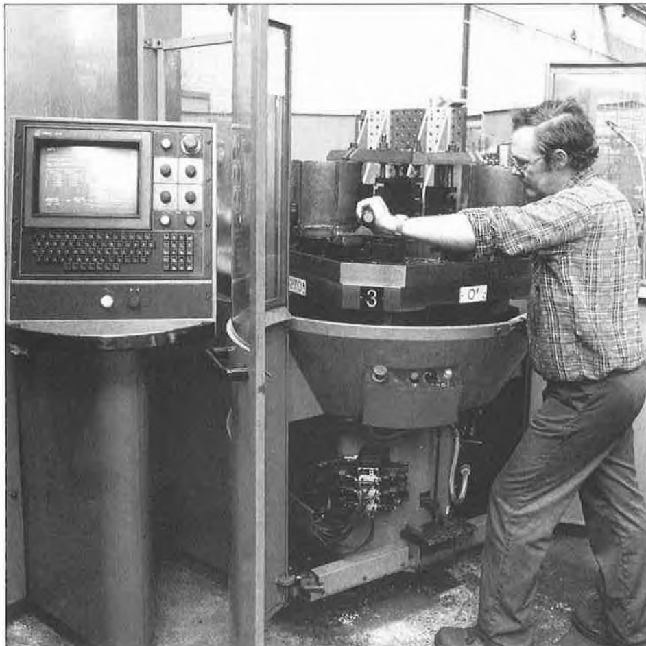
Mise en place de pièces à usiner sur centre d'usinage CNC. Centre de 16 kW - 6 palettes - magasin de 80 outils - vitesse max de broche 3.500 tr/min (visite, n° 5).
