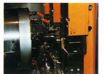
Centre d'usinage à commande numérique OLIVETTI HORIZON 700L. Table de 800 x 800 mm, charge de 800 kg, vitesse maximale de 3500 tours/minute et magasin de 80 outils (photos 6, 7 et 8).
