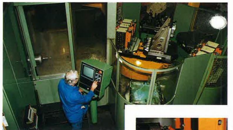
Centre d'usinage à commande numérique OLIVETTI HORIZON 700L. Table de 800 x 800 mm, charge de 800 kg, vitesse maximale de 3500 tours/minute et magasin de 80 outils (photos 6, 7 et 8).
