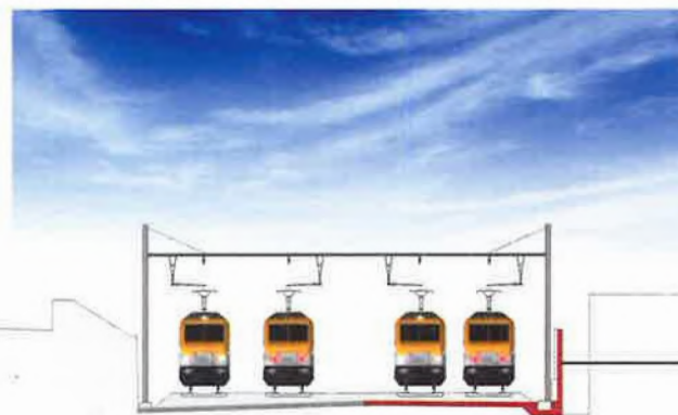
Type-dwarsdoorsnede van een lijn die op 4 sporen wordt gebracht
