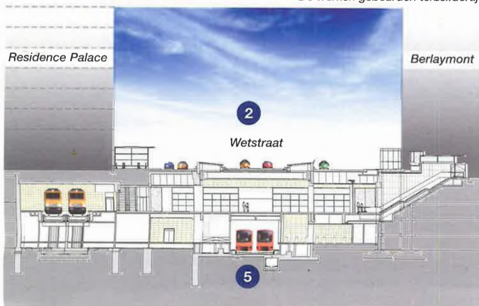
7 Een deel van het nieuwe station Brussel-Schuman is al gebouwd, met name het gedeelte onder het Berlaymontgebouw. De werken gebeurden terzelfdertijd als de renovatie van dat gebouw.
