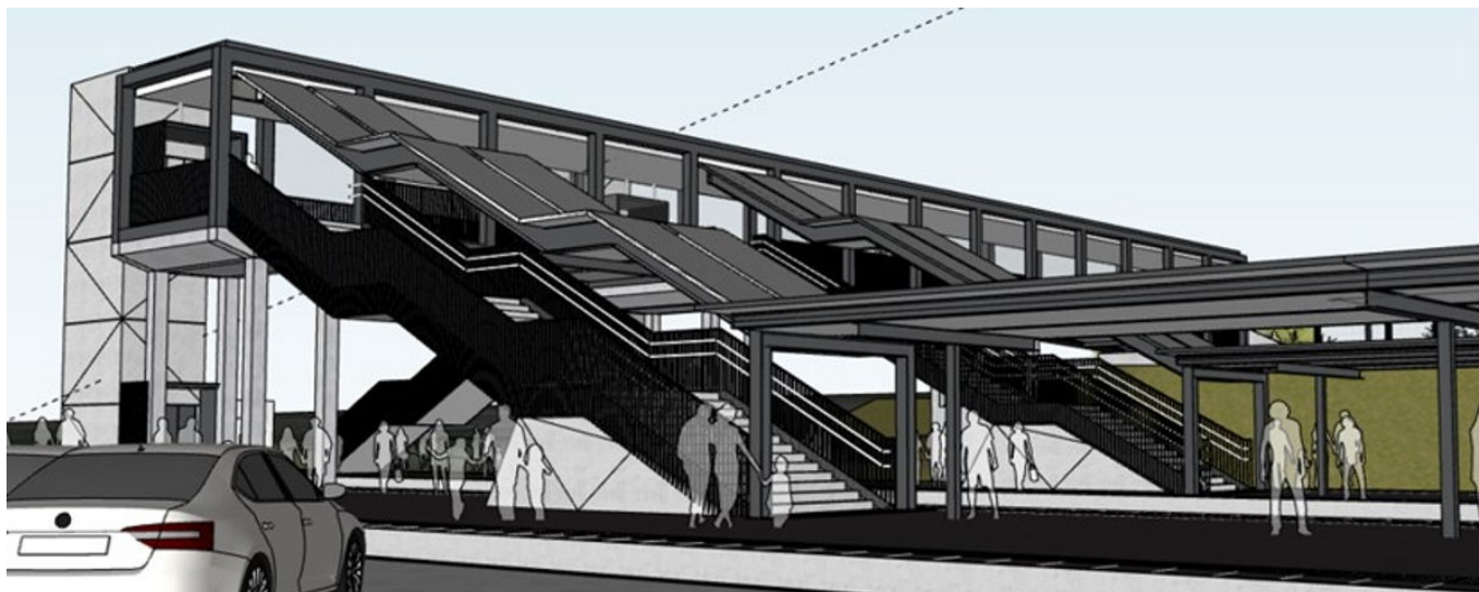
De nieuwe overdekte voetgangersbrug, met een lift en een trap naar elk perron.
