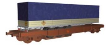
Dans les pays dans lesquels une plaque étiquette doit être placé sur les côtés latéraux de la semi-remorque, il n'est pas nécessaire d'en apposer sur le wagon.
