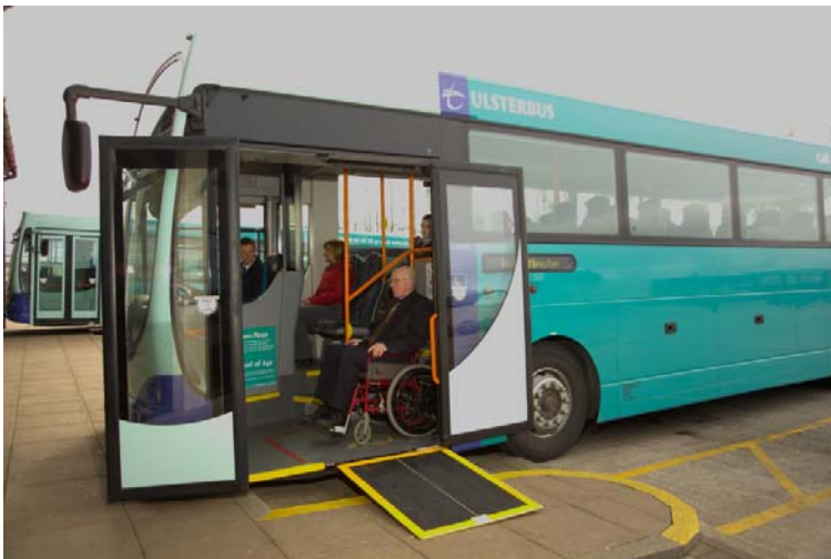
Photo 21. Autobus à plancher haut avec rampe d'accès au niveau inférieur
