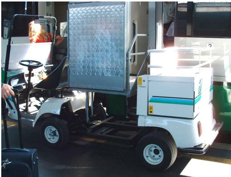
Photo 15. Élévateur Trenitalia pour les voyageurs en fauteuil roulant
