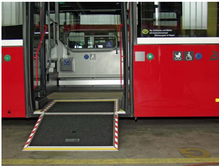
Photo 18. Rampe manuelle sur un autobus à plancher surbaissé
