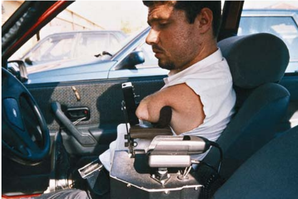
Photo 27. Des commandes très perfectionnées permettent aujourd'hui à de nombreuses personnes gravement handicapées de conduire en toute sécurité et confortablement
