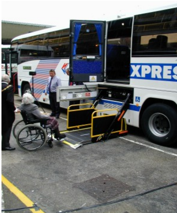
Photo 20. L'accès à un autocar à plancher haut est possible avec un élévateur intégré
