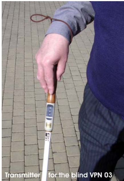
Photo 10. Le transmetteur Apex signale l'intention de monter à bord du véhicule
