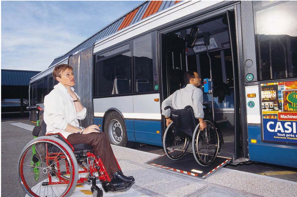
Photo 17. Rampe d'accès aux autobus à Grenoble
