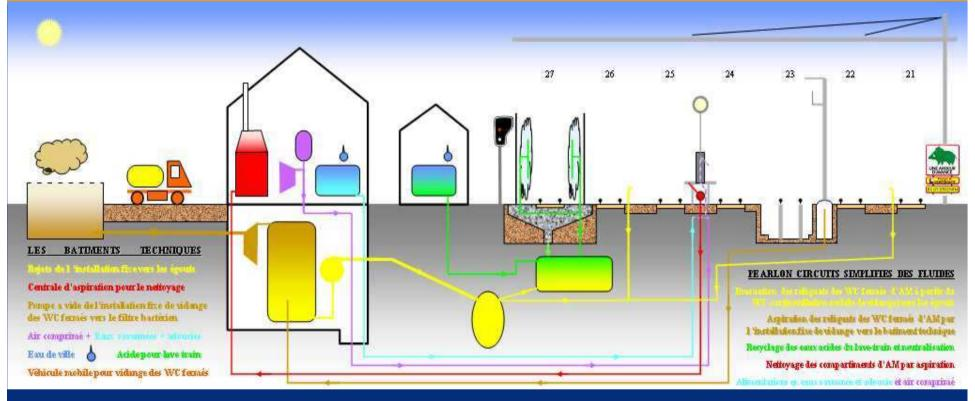
Le poste d'entretien d'Arlon est équipé d'un lave train, de vidanges de « WC fermés » centralisée et mobile, d'une plate-forme pour faciliter le nettoyage intérieur des engins, d'une fosse et d'une plate-forme de visites
