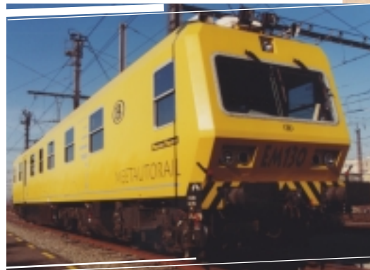
Een meetmotorwagen registreert twee maal per jaar de algemene toestand van de sporen.
