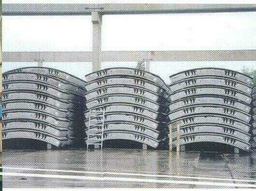
In totaal zullen 13.000 tunnelsegmenten van ongeveer 5 ton worden gebruikt voor de realisatie van de 1200 meter lange tunnelkokers.
