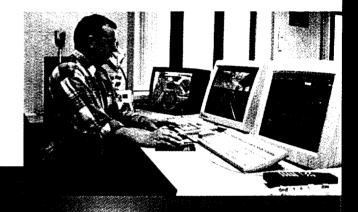
Un seul simulateur permet de confronter le conducteur à toutes les situations imaginables. Au cours d'un exercice de simulation, le conducteur parcourt un trajet donné, au cours duquel divers incidents sont provoqués: difficultés au niveau de la traction ou des freins, signalisation défectueuse, problèmes aux passages à niveau, trains en difficulté, ...
