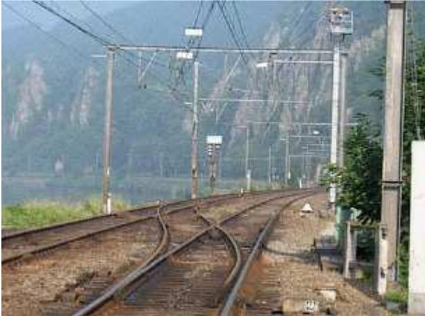
Een **wisselverbinding** is het geheel van twee wissels met hun aansluitrails dat twee gelijklopende sporen met elkaar verbindt.
