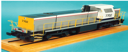
Locomotief reeks 77: rangeer- en lijnlocomotief (goederen)
