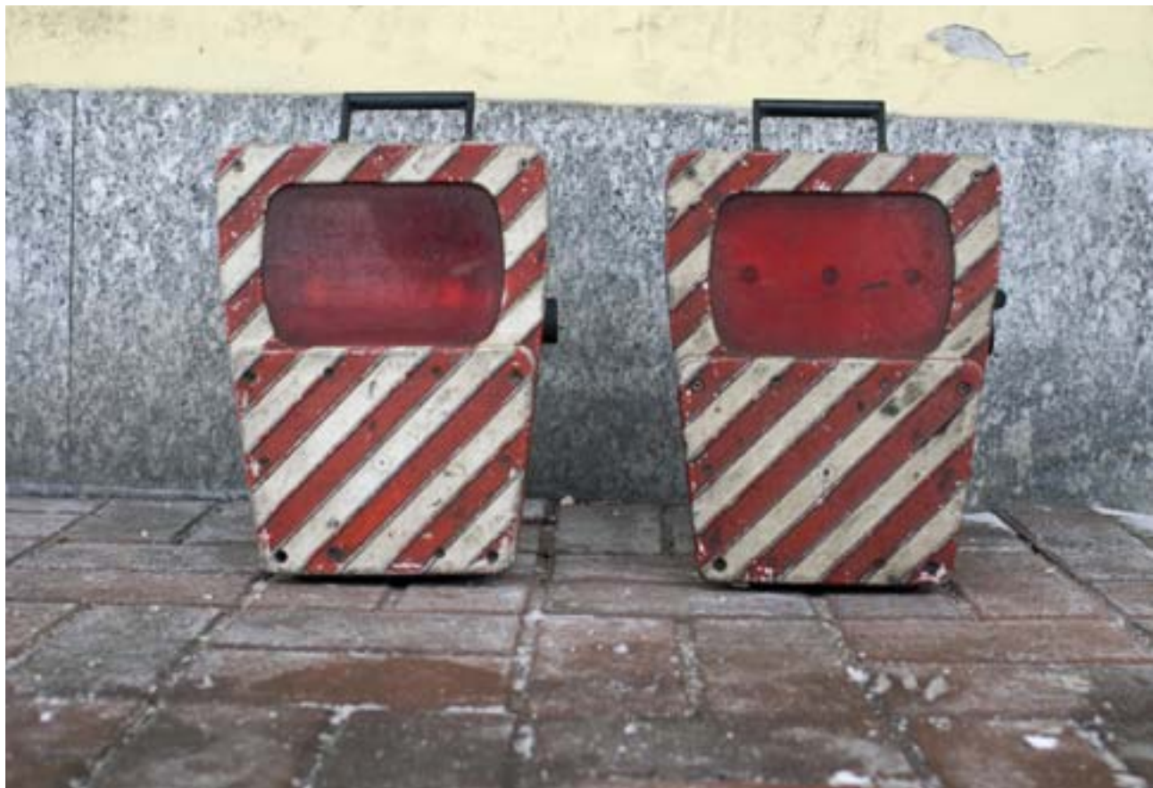
Foto 9 — In Italië verplichte sluitlichten die moeten worden bevestigd aan de trein in station Brennersee
