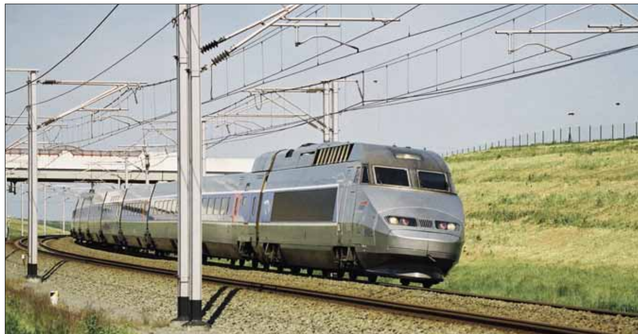
▼ Eens op volle snelheid gebruik een HST enkel de achterste stroomafnemer
