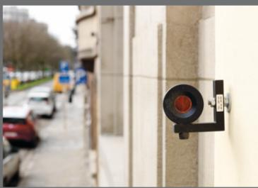
Des systèmes de mesure contrôlent de manière continue les différentes zones du chantier. Tout déplacement horizontal ou vertical d'un bâtiment est immédiatement recensé et des dispositions de compensation des tassements et des vibrations sont mises en route en fonction de certains seuils de sécurité.
