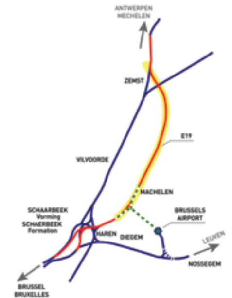
Het Diaboloproject creëert een oplossing voor een 'missing link' in het spoorwegennetwerk.
