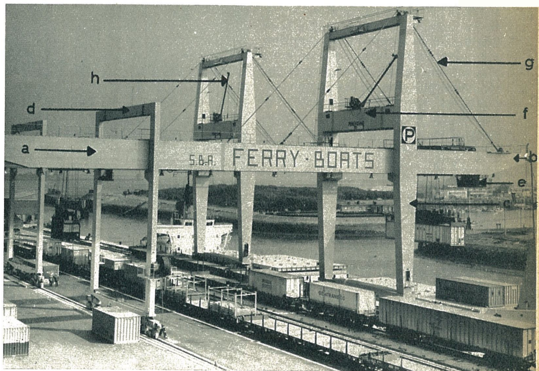
Fig. 1 — Portaalkranen : a) hoofdbalk ; b) voorbalk ; c) vaste poot, e) loopkat en cabine ; f) machinekamer ; g) trekstang ; h) onderhoudskraan.
