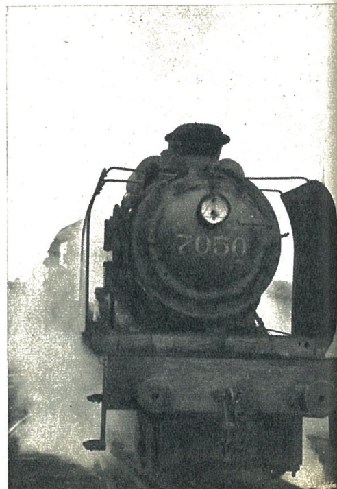
De uitwendige verbouwingen die het oorspronkelijke silhouet van de locomotieven wijzigden. Hiernaast, het verbouwde type 7 (uitlaat Lemaitre, A.C.F.I., leiplatten).
