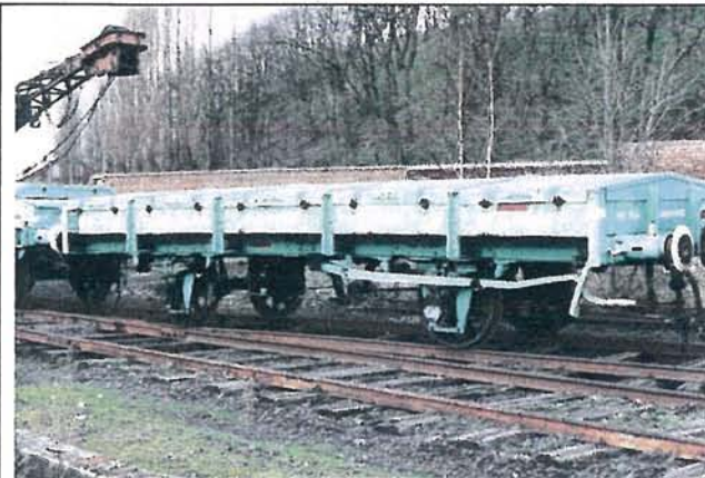
Wagon étalon de bascule 30 T (photo G. Grépier)
