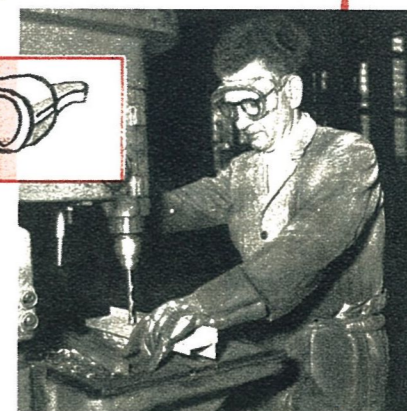
Veiligheidsbril voor bedienden die verbeterglazen dragen. (Werken waarbij er gevaar bestaat voor oogkwetsuren door scherven).
