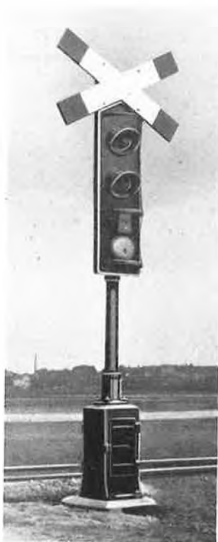
Fig. 18. Signal de passage à niveau. (Pied du mât formant coffret d'appareillage.)
