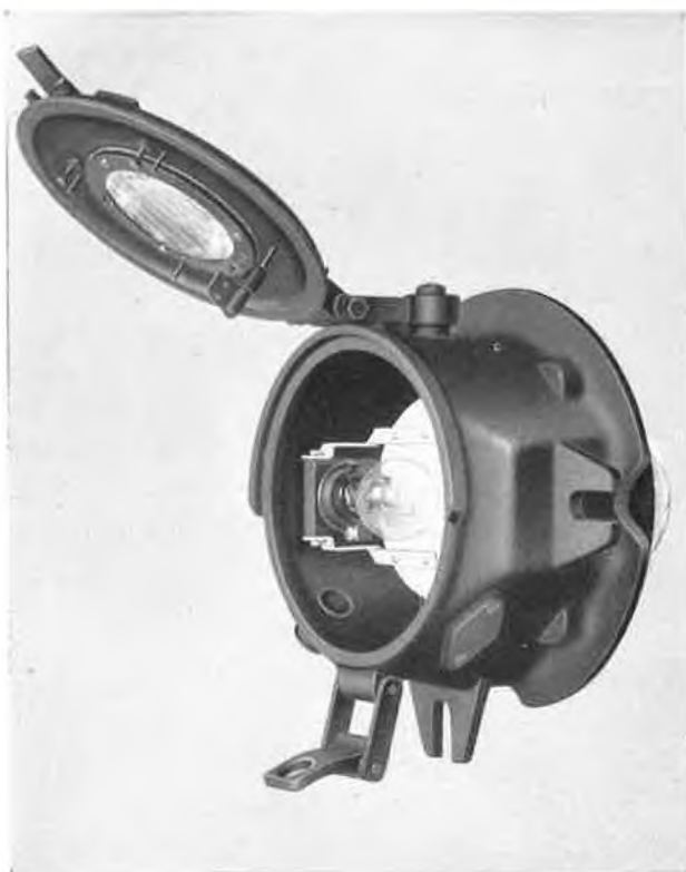
Fig. 7b. Lanterne avec lentille massive et feu arrière par lentille massive.
