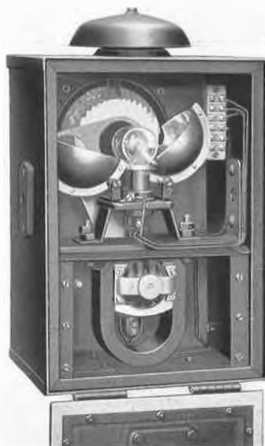
Fig. 10b. Signal-relais pour lumière du jour (déplacement de l'obturateur par aimant tournant). Réflecteur ouvert.
