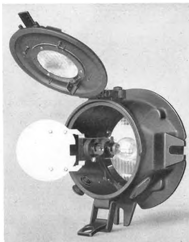
Fig. 7c. Lanterne avec lentille massive et feu arrière. (La paroi de séparation est rabattue à l'extérieur pour le changement de la lampe avant.)
