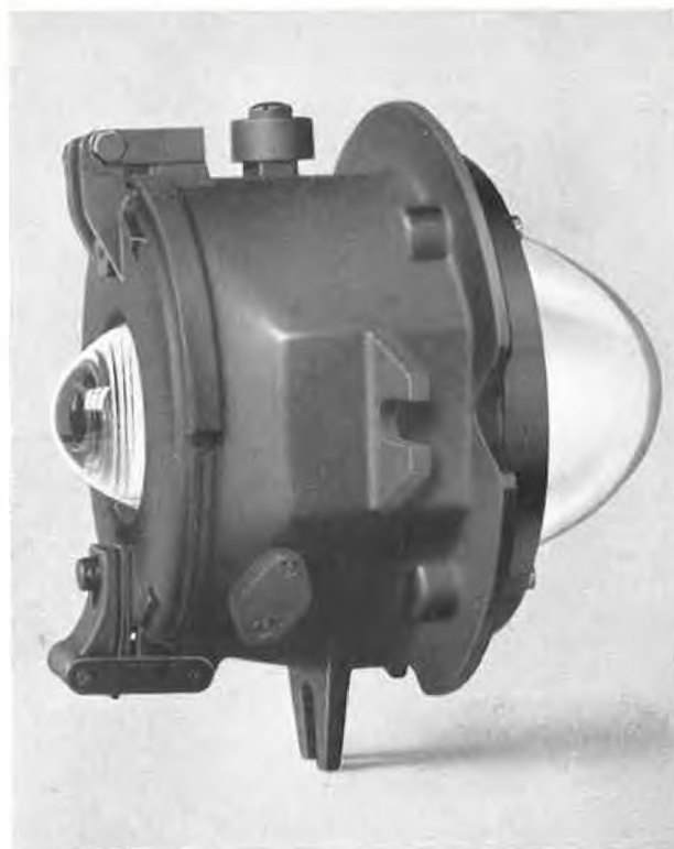
Fig. 7a. Lanterne avec lentille massive et feu arrière par lentille massive taillée.
