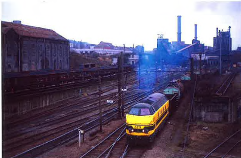
Un train de fonte en fusion quitte le haut-fourneau d'Ougrée – à gauche, rame de wagons de coke (janvier 2003)
