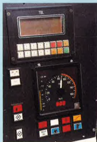
▲ «CAB-DISPLAY»: SCHERM MET ALLE SEININFORMATIE
