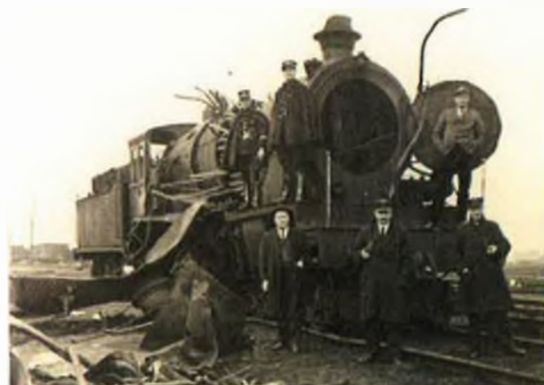
▲▲ Ketelexplosie Belgische locomotief type 9 te Baarle-Nassau (1932)
