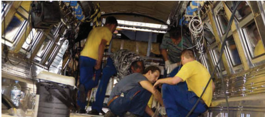
L'installation des câbles dans les voitures est une opération très complexe.
