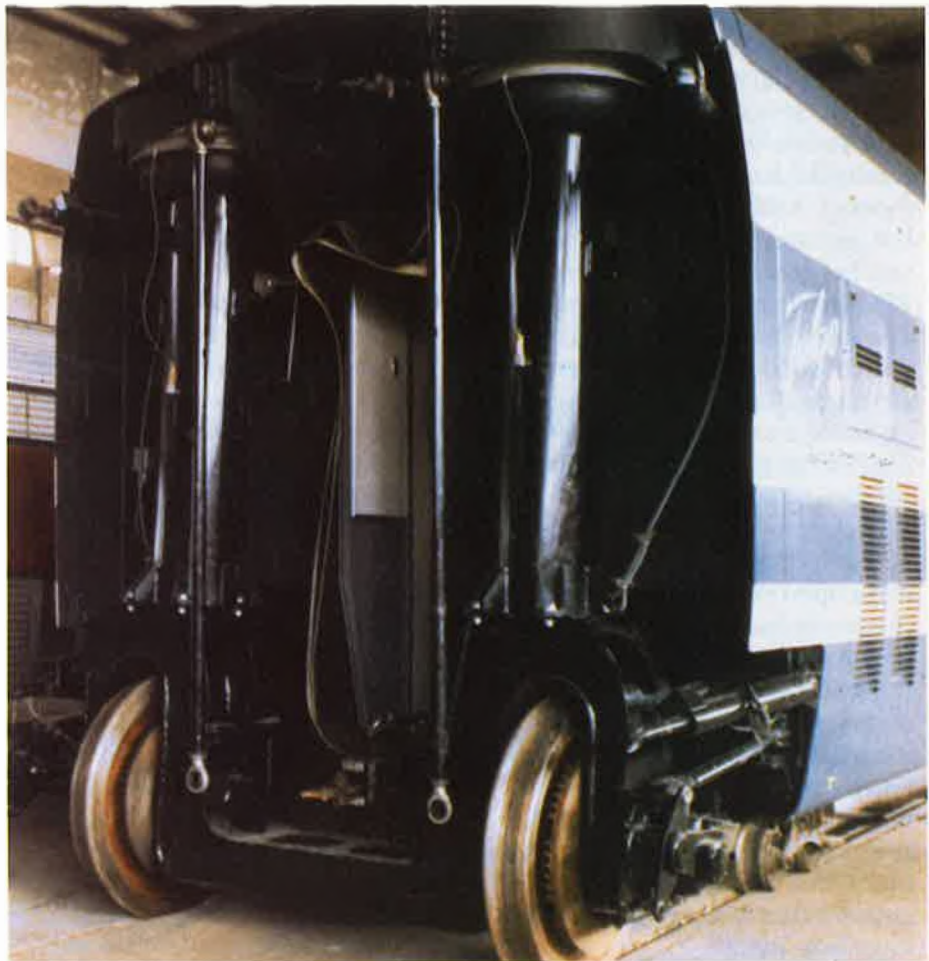
Zie de kokers boven de wielen plus de luchtbalgen en de speciale wielophanging
