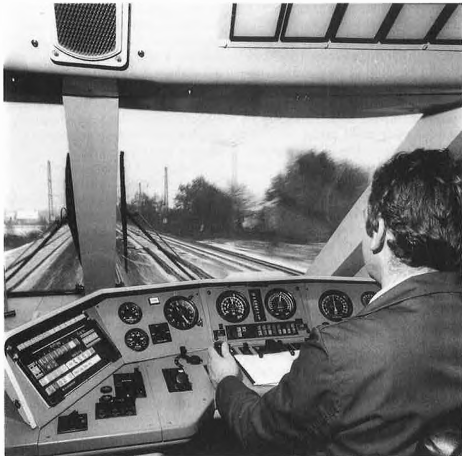
De moderne stuurtafel in de ICE. De bestuurder krijgt meldingen over de kwaliteit van verschillende technische onderdelen, ook vóór het vertrek van de trein.
