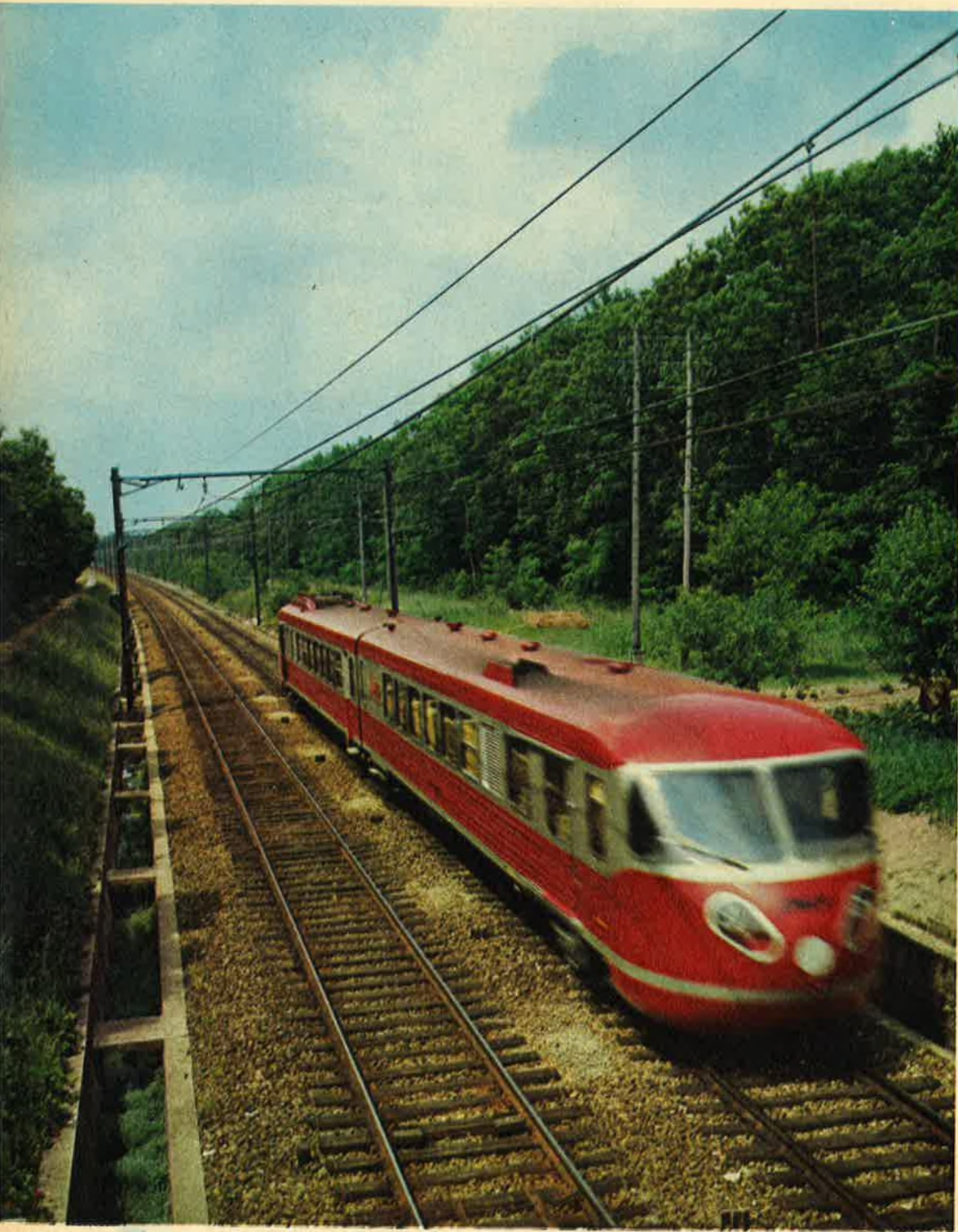
Autorail prototype français à turbine, dénommé « turborail », en cours d'essai de vitesse sur la ligne Les Aubrais-Vierzon. (Photo Pilloux, « La Vie du Rail ».)
