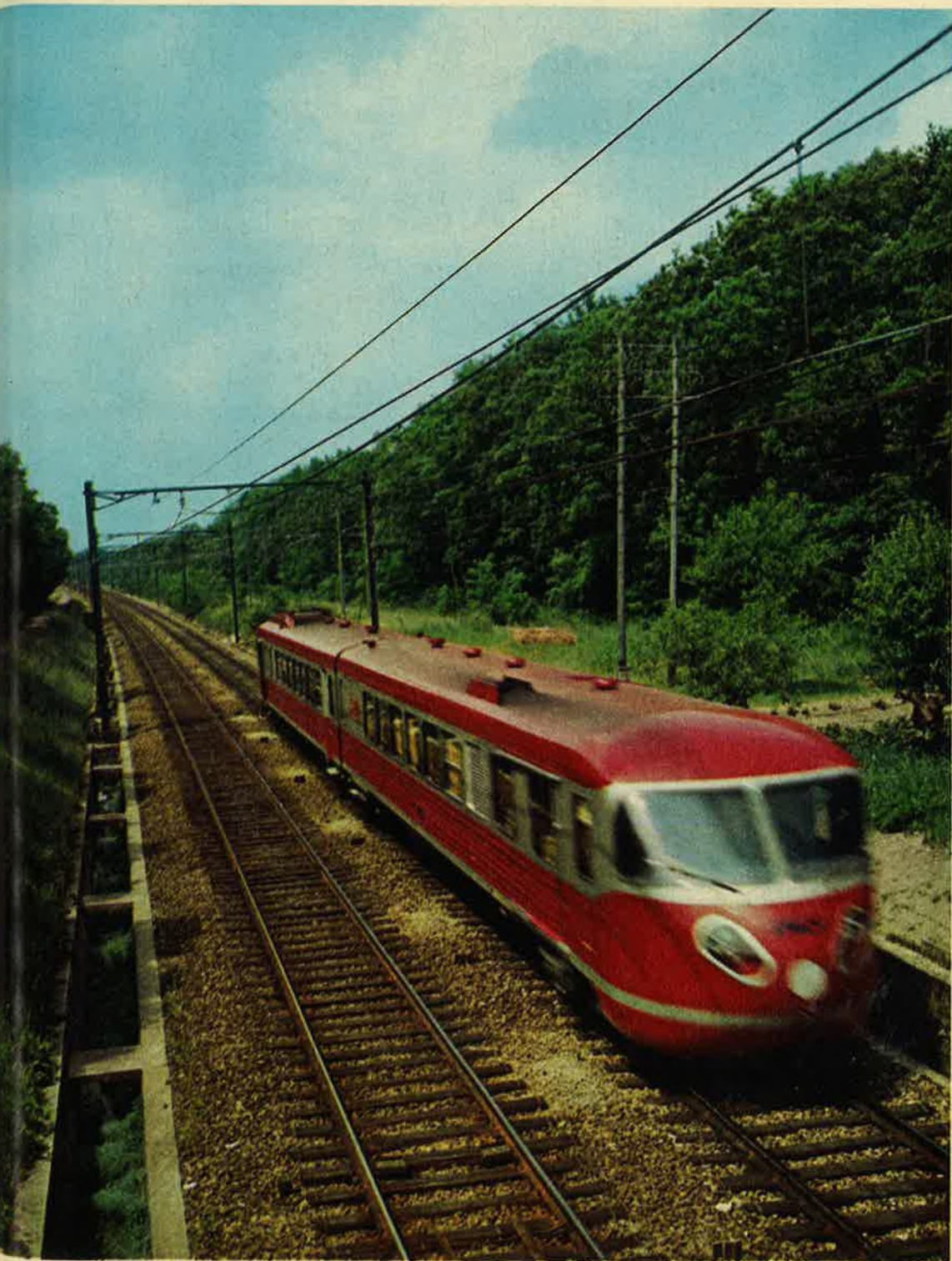
Prototype van een Frans motorrijtuig met turbine, turborail genaamd, dat voor het ogenblik snelheidsproeven aflegt op de lijn Les Aubrais-Vierzon. (Foto Pilloux, « La Vie du Rail ».)
