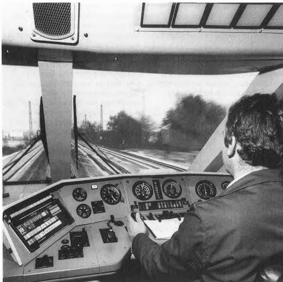
Le pupitre de commande moderne de l'ICE. Le conducteur reçoit des informations sur la qualité des différents éléments techniques même avant le départ du train.
