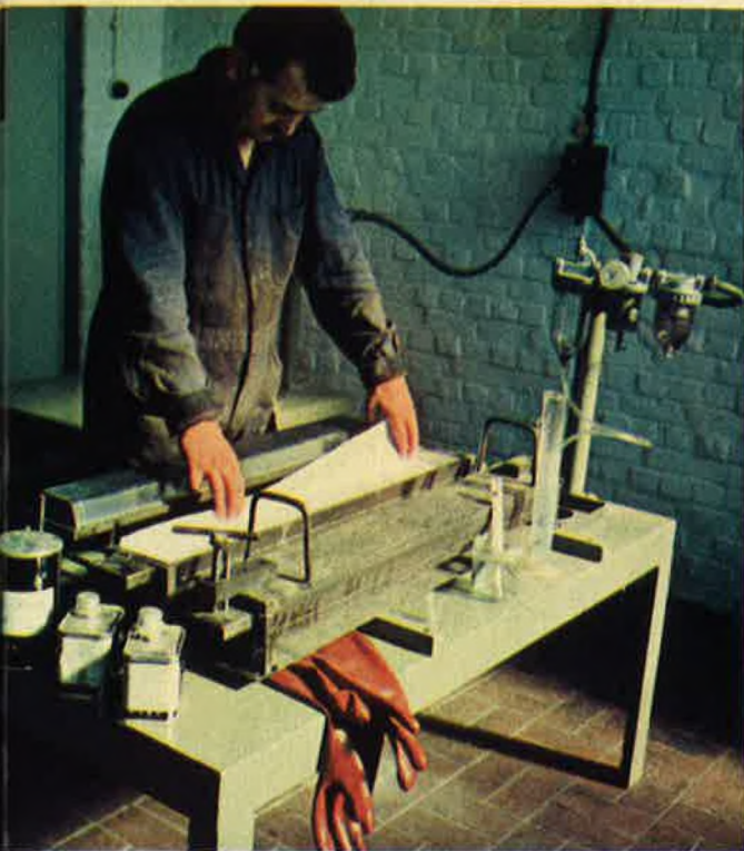
De fabricatie van een isolerende « voorvorm ».
