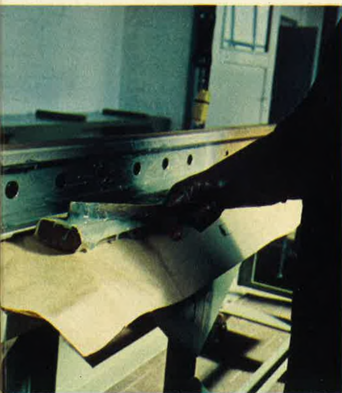
Het aanbrengen van de lijm.
