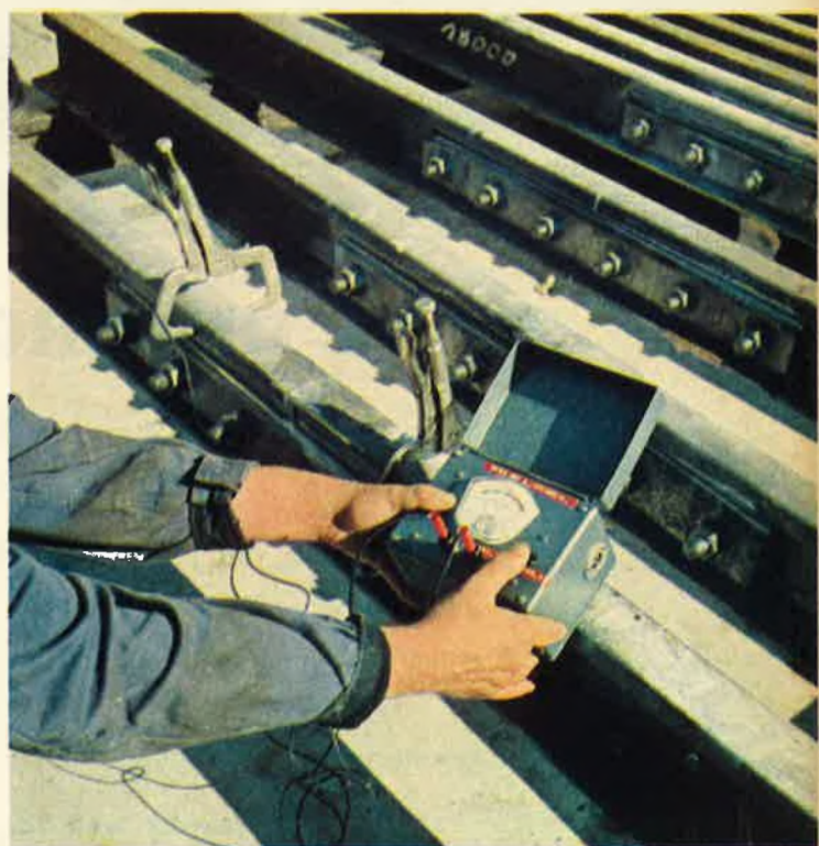
De elektrische isolatie van elke voeg wordt vóór de verzending nagezien.
