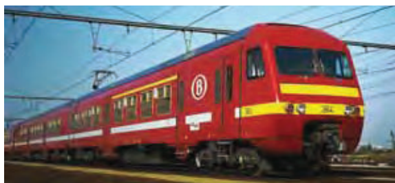
De oorspronkelijke tweeledige Breaks in Bordeaux-rood waren krachtige motorstellen, geschikt voor snelheden tot 160 km/u, die meer ruimte boden en beter rijcomfort dan de oudere motorstellen.
