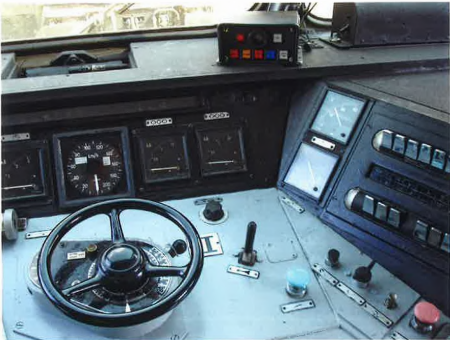
Het bedieningskastje van TBL1+ werd in locomotief 2025 op de legplank onder de voorruit opgesteld. Ergonomie was toen nauwelijks aan de orde. De bestuurder werd geacht een lange arm te hebben. Let ook op de grote blauwe drukknop: de witteerknop. 3 augustus 2009, foto: Hans Joosen
