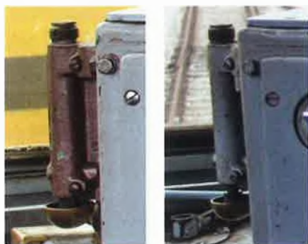
Links een Teloc-fluit in rusttoestand en rechts een geactiveerde. De machinist heeft nog vier seconden om dat halve bolletje naar boven te duwen. Indien hij faalt, gebeurt een automatische noodstop. Foto's: Hans Joosen
