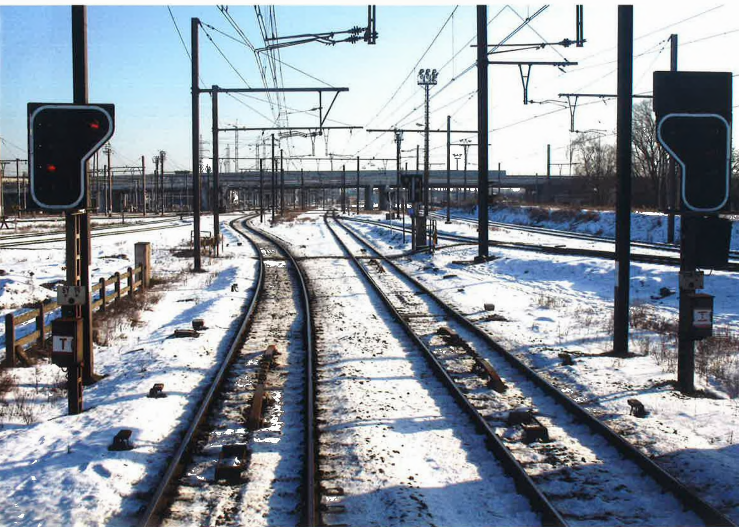
Deze lijnconfiguratie van 10 januari 2014 bij het binnenrijden van het station Hasselt via lijn 35 bestaat niet meer. Op de voorgrond is tussen beide rails van elk spoor telkens een inductiespoel van de TBL1 (rechthoekig langwerpig ijzeren bakje) merkbaar. Daarachter ligt eveneens een krokodil voor de Memor. Foto: Hans Joosen
