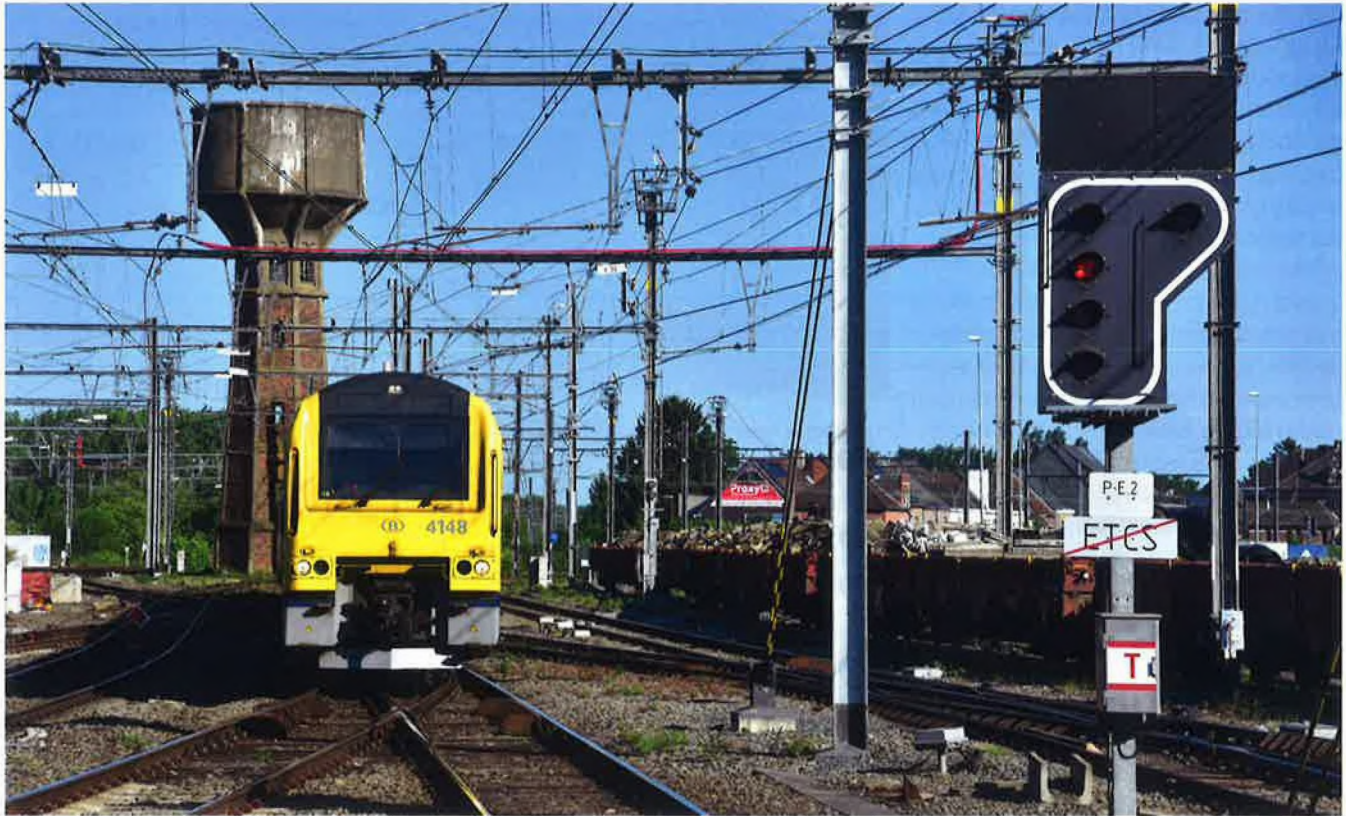
Een dieselmotorwagen rijdt het station Denderleeuw binnen uit de richting Brussel of Geraardsbergen. Hij vertrekt over korte tijd als P-trein naar Geraardsbergen. Rechts staat het bordje dat het einde van een traject met ETCS Full Supervision aanduidt. Het geldt voor lijn 90 richting Ninove. In de achtergrond de getuige uit de stoomtijd die boven de 41 uittoert. Infrabel plant de watertoren tijdens het Pinksterweekeinde 2025 voor de zoveelste keer te slopen. Alle vorige pogingen faalden. Foto: Ben Lanoot
