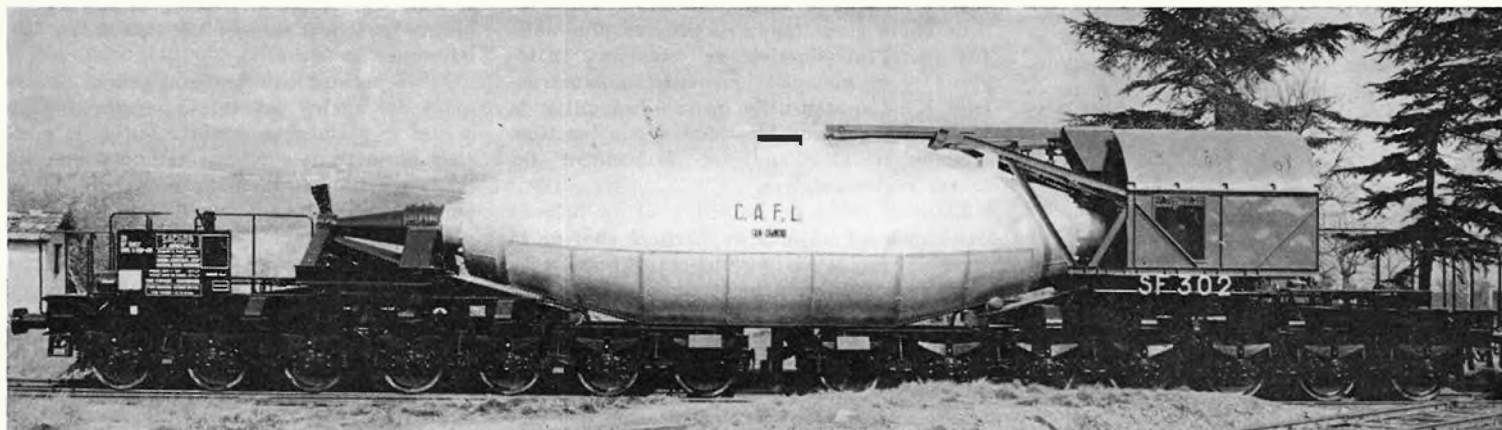
FIG. 1. — Le wagon-poche de 150 t pour transport de fonte liquide construit par la Compagnie des Ateliers et Forges de la Loire.
