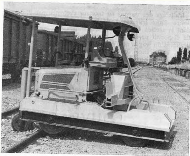
FIG. 1. — Le locotracteur Unilok en position au cours d'une manœuvre de passage de la circulation routière à la circulation ferroviaire.
