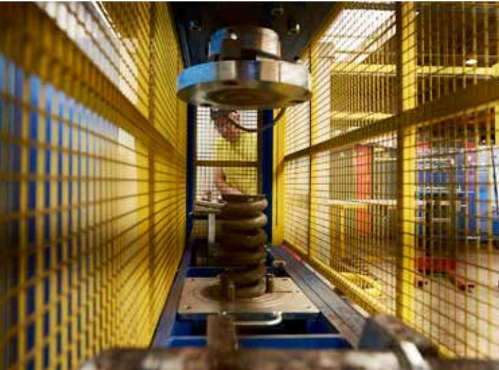
Nous testons les ressorts à lames et hélicoïdaux sur notre banc d'essai de ressorts.
