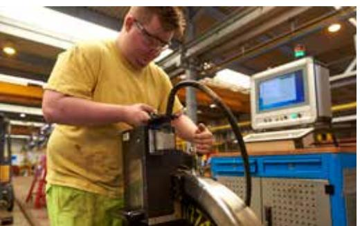
L'essai non destructif est effectué conformément à la DIN 27201-7 (VT, PT, MT et UT).
