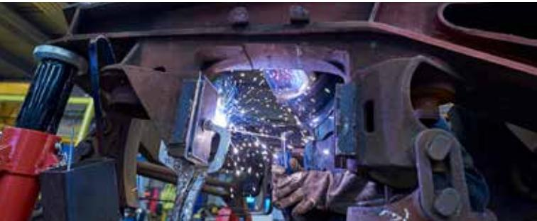
Les réparations par soudage, notamment de fissures, sont effectuées conformément au certificat 15085-2 par une équipe de soudeurs et d'ingénieurs soudeurs hautement qualifiée.
